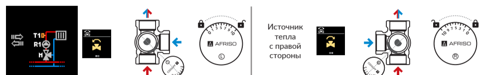
Рис. 10. Схема с 3-ходовым смесительным клапаном ARV Vario ProClick на подаче (поверхностное или радиаторное отопление). Выбирается, чтобы подключить очередной контроллер в связи BUS
