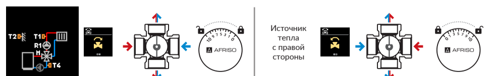
Рис. 11. Схема с 4-ходовым смесительным клапаном (поверхностное или радиаторное отопление) с функцией защиты температуры возврата
