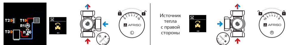
Рис. 9. Схема с 3-ходовым смесительным клапаном ARV Vario ProClick на подаче (поверхностное или радиаторное отопление)
