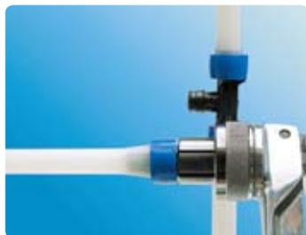
2. Расширьте конец трубы при помощи расширительного инструмента.
