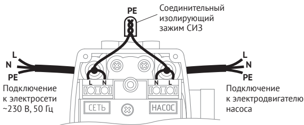
Рисунок 4 - Электрическая схема подключения
